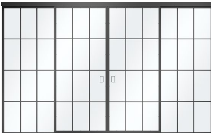
2-skrzydłowe drzwi przesuwne z 2 naświetlami bocznymi oraz 3 poziomymi i 2 pionowymi szprosami, listwa przyszybowa typu Slim
